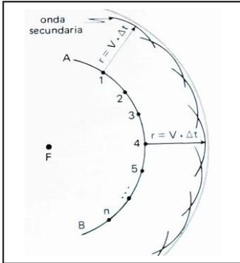
72\*. Sean 1,2... los puntos alcanzados por el frente de ondas, creado por la perturbación en F, al originar ondas secundarias, surgirá un nuevo frente de ondas circular que abarca las ondas secundarias como el de la figura, de las podrás asegurar que tienen:
