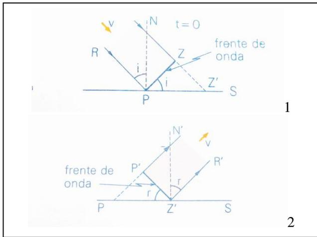
78\*. En la figura 1, se describe la incidencia de un frente de ondas, compuesto por 2 rayos y en la 2 la reflexión de ese mismo frente al alcanzar la superficie S. Teniendo en cuenta el concepto de ángulo de incidencia  $i$  y de reflexión  $r$ , como ángulos que forman los rayos respectivos con sus normales  $N$  y  $N'$ , y que la velocidad de propagación es la misma, se concluirá que:
