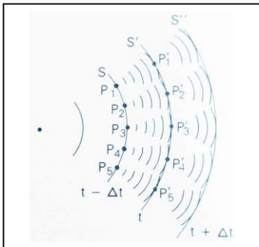
74\*. Volviendo al foco puntual, como las ondas secundarias que se inician en los sucesivos puntos  $P_1, P_2, P_3, \dots$  tienen la misma longitud de onda y velocidad, los siguientes frente de ondas secundarias serán círculos que se diferenciarán en
